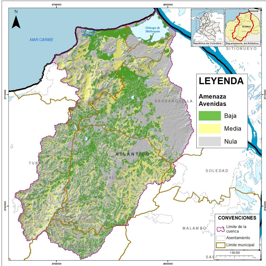
Figura 4.34. Amenaza por Avenidas Torrenciales
