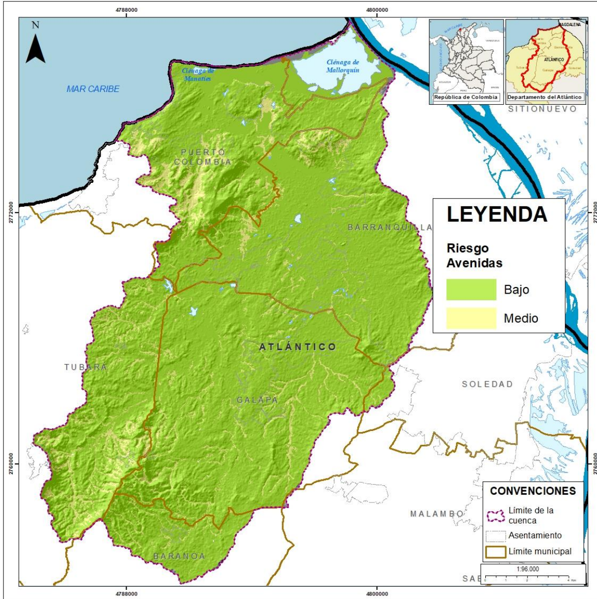
Figura 6.5. Escenario de riesgo por avenidas torrenciales
